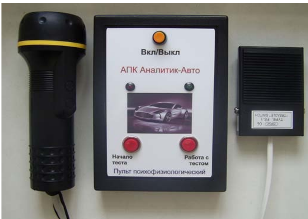
Рисунок 3. Пульт с датчиками и светодиодами и устройство для выполнения тестов, осуществляемых через зрительную сенсорную систему в виде трубы со светодиодами (входит только в комплект поставки АПК Аналитик-авто расширенный).
